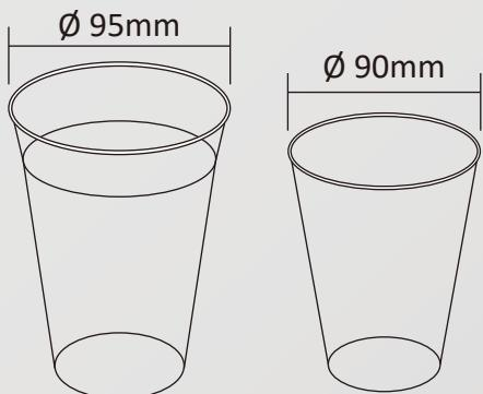
公版規格適用Ø95mm PP膠杯及Ø90mm PE紙杯，其他尺寸容器亦可客製化訂做模具。
